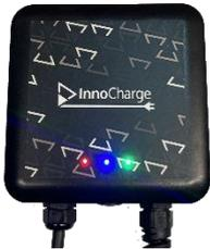
Nachdem der InnoCharge mit Spannung versorgt wurde, leuchten alle LED's für kurze Zeit auf und danach blinkt die grüne LED für ca. 20 Sekunden. Dann leuchtet diese dauerhaft und signalisiert somit eine Betriebsbereitschaft.
